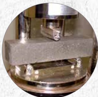
Resistenza a flessione (Laboratorio R&S Mapei)
