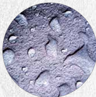
Ingrandimento di gocce d'acqua sul film di Silancolor (Laboratorio R&S Mapei)
