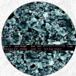
Analisi al microscopio elettronico (ESEM - FEG) dell'insieme supporto/finitura ai silicati (Laboratorio R&S Mapei)
