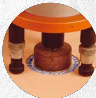
Prova di pull-out (Laboratorio R&S Mapei)
