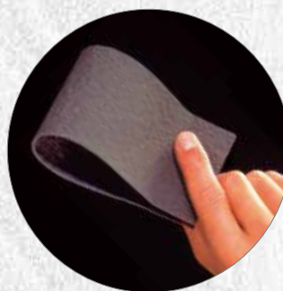
Prova di elasticità di Mapelastic (Laboratorio R&S Mapei)
