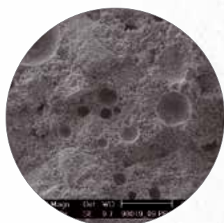
Ingrandimento della struttura macroporosa di Mape-Antique (Laboratorio R&S Mapei)
