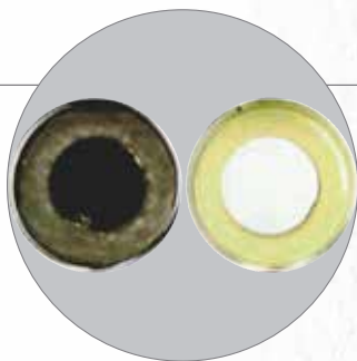
Prova di resistenza alla crescita di muffe in capsula di Petri (Laboratorio R&S Mapei)
