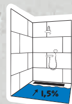
wykonanie warstwy spadkowej w kabinie
