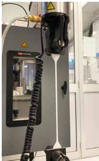
Laboratorium MAPEI: test na wydłużenie
