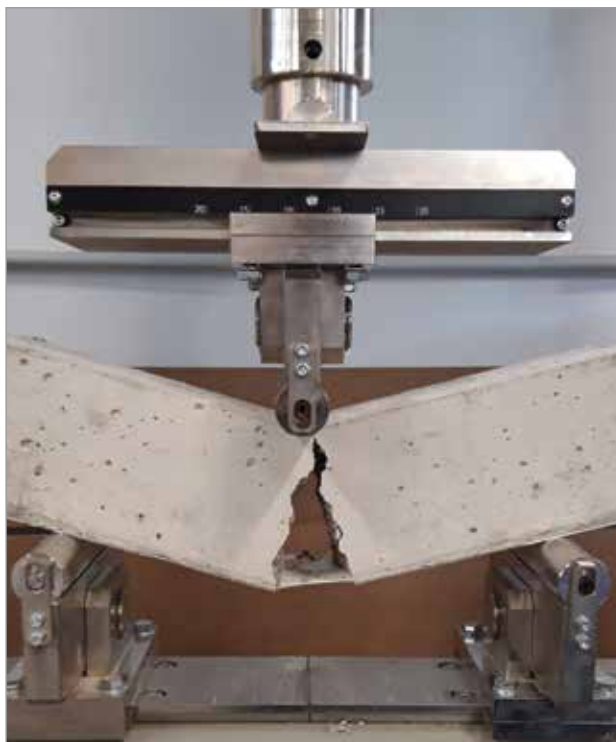
Zdjęcie wykonane w laboratorium pokazujące zdolność Mapeproof FBT do mostkowania pęknięć.
