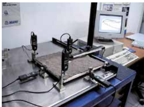
Prova di imbarcamento (secondo metodo definito dalla EN 14617-12)
