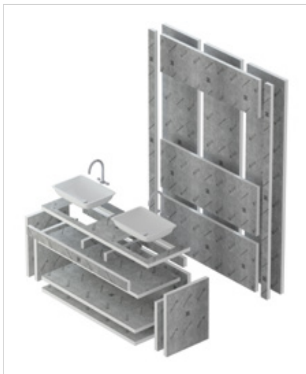
Създаване на носеща повърхност за монтаж на умивалници
