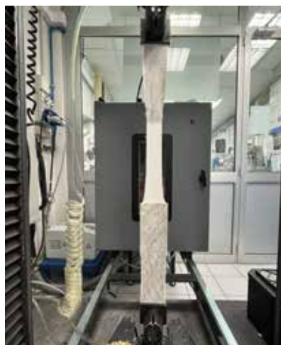
Марей: лабораторен тест на надлъжно удължение на снагката SealLap.
