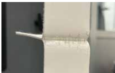
Марей: лабораторен тест на отлепяне на снагката SealLap.
