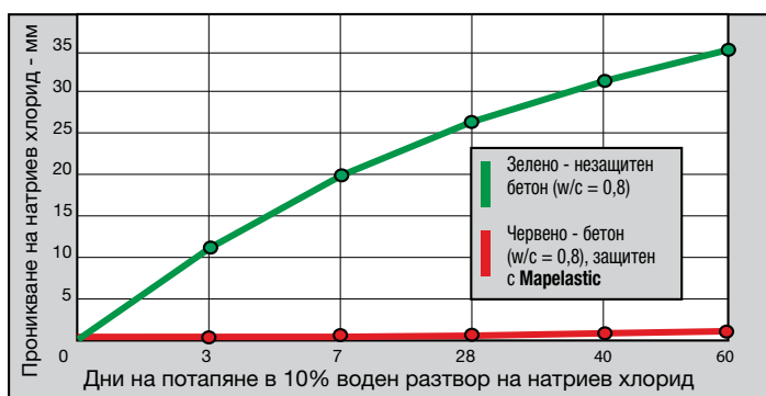
Фиг. 3: Защита с Mapelastic срещу проникване на натриев хлорид в порьозен бетон
