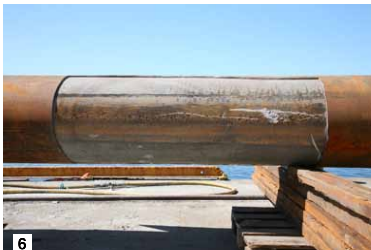
图 5. 注入混合搅拌砂浆前要检测管道状况。
