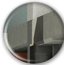
**2. Upotrebom tkanina od karbonskih vlakana iz sustava FRP ostvaruje se lokalizirano ojačanje spojeva između greda i stupova.**
