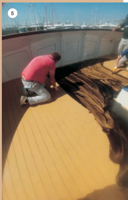
SLIKA 3: Freziranje utora specijalnim alatom. SLIKA 4: Priprema prije nanošenja mase za fugiranje MAPEDECK CAULKING. SLIKA 5: Nanošenje mase MAPEDECK CAULKING. SLIKA 6: Nanošenje zaštite MAPEDECK WAX. SLIKA 7: Završni izgled sustava MAPEDECK TEAK DESIGN.
