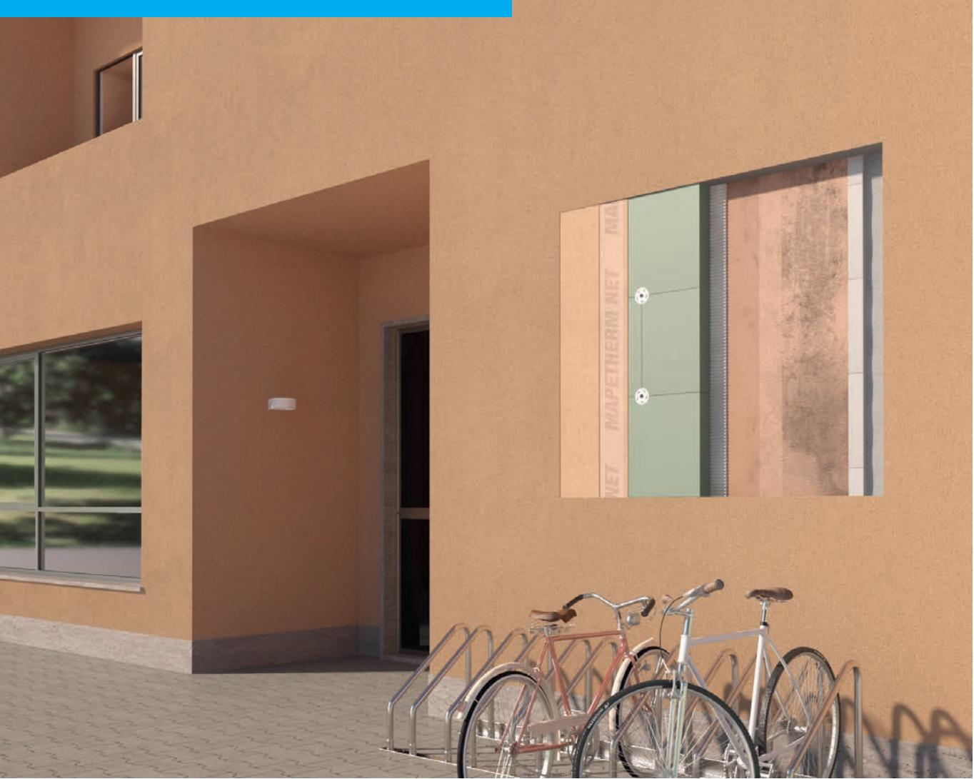
**SHEMA:** Prikaz slojeva koji čine Mapetherm X2 sustav.
