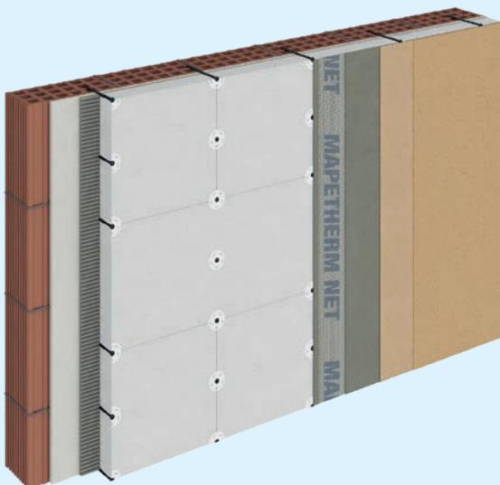
**SHEMA:** Presjek sustava vanjske toplinske izolacije s prikazom svih njegovih sastavnih dijelova počevši od podloge: ljeplilo, izolacijska ploča, elementi za pričvršćivanje, mort za zaglađivanje s ugrađenom mrežom za ojačanje od staklenih vlakana, temeljni i završni premaz.
