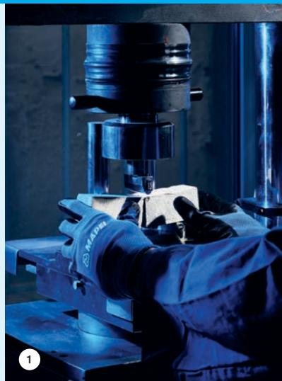
**SLIKA 1:** Ispitivanje savojne čvrstoće proizvoda MAPETHERM u skladu s normom EN 998-1.
