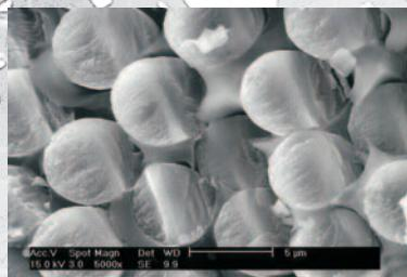
Obr. 1: Mikrofotografie strukturálního kompozitního materiálu s polymerickou matricí.
