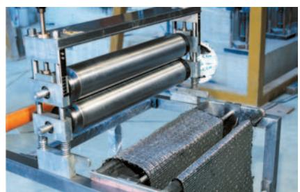
Obr. 13: Strojní impregnace MAPEWRAPu C
