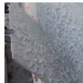
Vynikající schopnost pokrytí lepidlem mezi podkladem a rubovou stranou obkladového prvku
