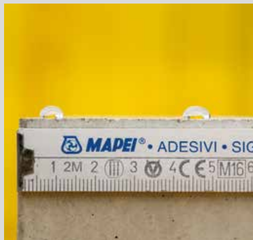
Penetrationsdybde i en betonprøve, behandlet med Planiseal WR 90 Gel
