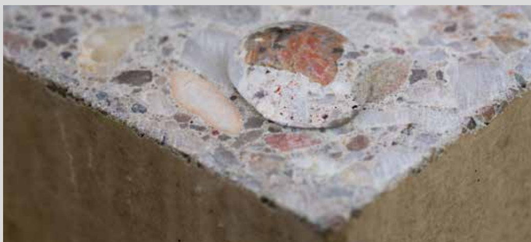
Drop Effect på en overflade, der er behandlet med Planiseal WR
