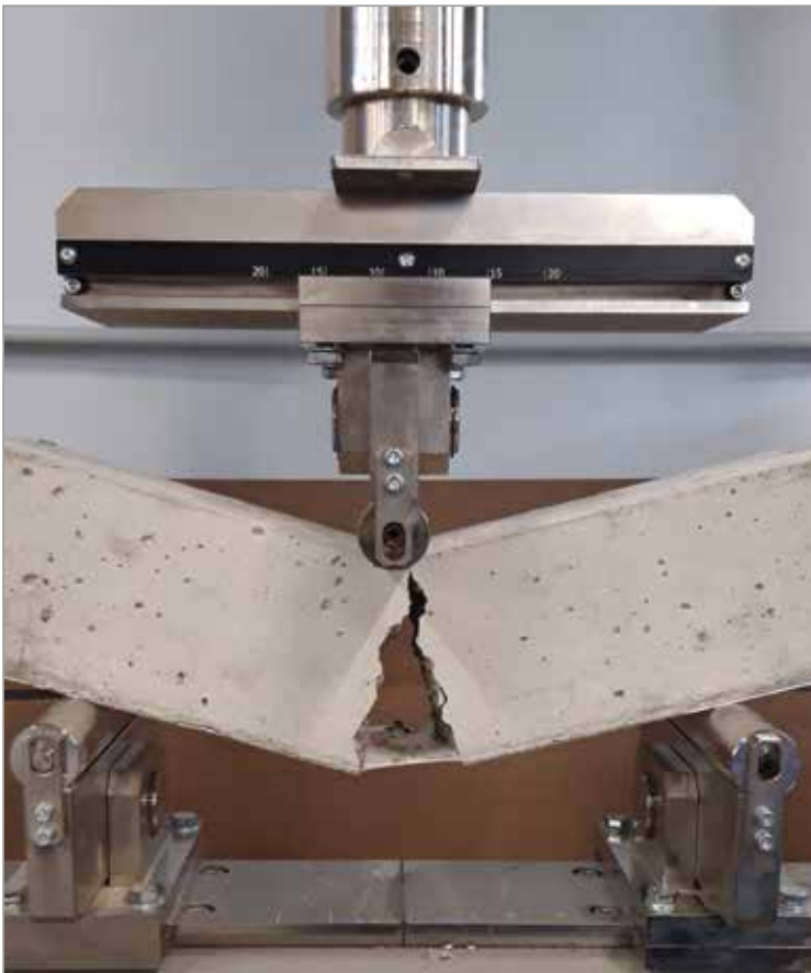
Laborfoto, das die Rissüberbrückungsfähigkeit von MAPEPROOF FBT zeigt.
