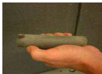
Weitere Werkzeuge zur Oberflächenprofilierung sind die openporige Füllschnur und der glatte, geschlossene Kunststoffschlauch. Über deren Oberfläche kann das Fugenbild wesentlich bestimmt werden.
