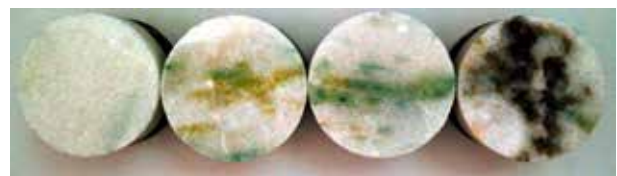
Verfärbung des Silikatmarmors Pinta Verde durch Veränderung des Oxidationszustandes des in einem Mineral enthaltenen Vanadiums
