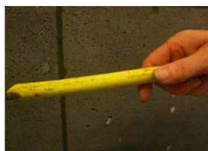
Weitere Werkzeuge zur Oberflächenprofilierung sind die openporige Füllschnur und der glatte, geschlossene Kunststoffschlauch. Über deren Oberfläche kann das Fugenbild wesentlich bestimmt werden.
