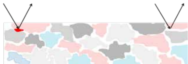
Schadenmechanismus durch Einlagerung von Fremdstoffen in die Kapillarporen des Gesteins
