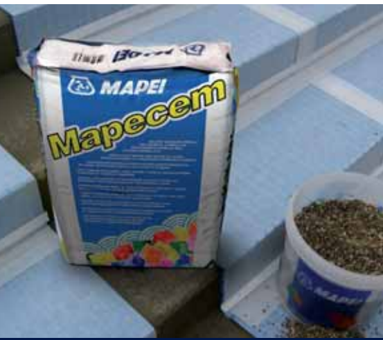
Geeignete Mischung zur Herstellung eines leistungsfähigen Drainmörtels unter Verwendung des Spezialbindemittels MAPEI MAPECEM im MV 1:4 mit Basaltsplitt (2–5 mm)
