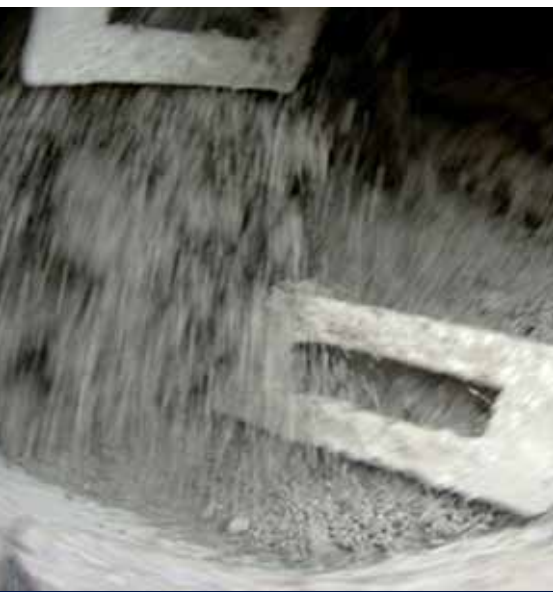
Mischen der Komponenten MAPECEM-Bindemittel und Basaltsplitt im Freifallmischer
