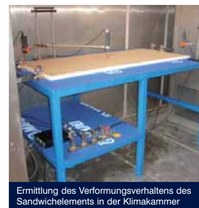
Verformungsverhalten des Sandwichelements bei einer Temperaturänderung von 20 °C (+20 °C bis +40 °C)
