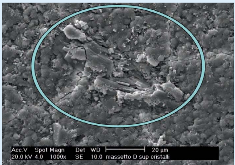
Bild 7: Rasterelektronenmikroskopaufnahme der Naturanhydritfließestrichoberfläche
