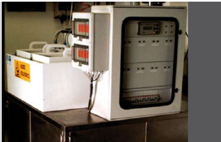
foto 2 Macchinario per la prova del contatto diretto
