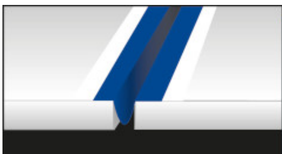
Poziționarea profilului Mapeband sub forma literei omega Ω, în interiorul unui rost de dilatare
