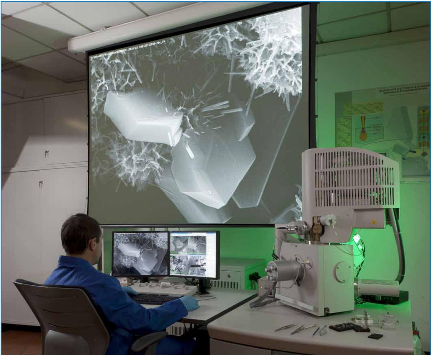
Microscopio electrónico ESEM-FEG
