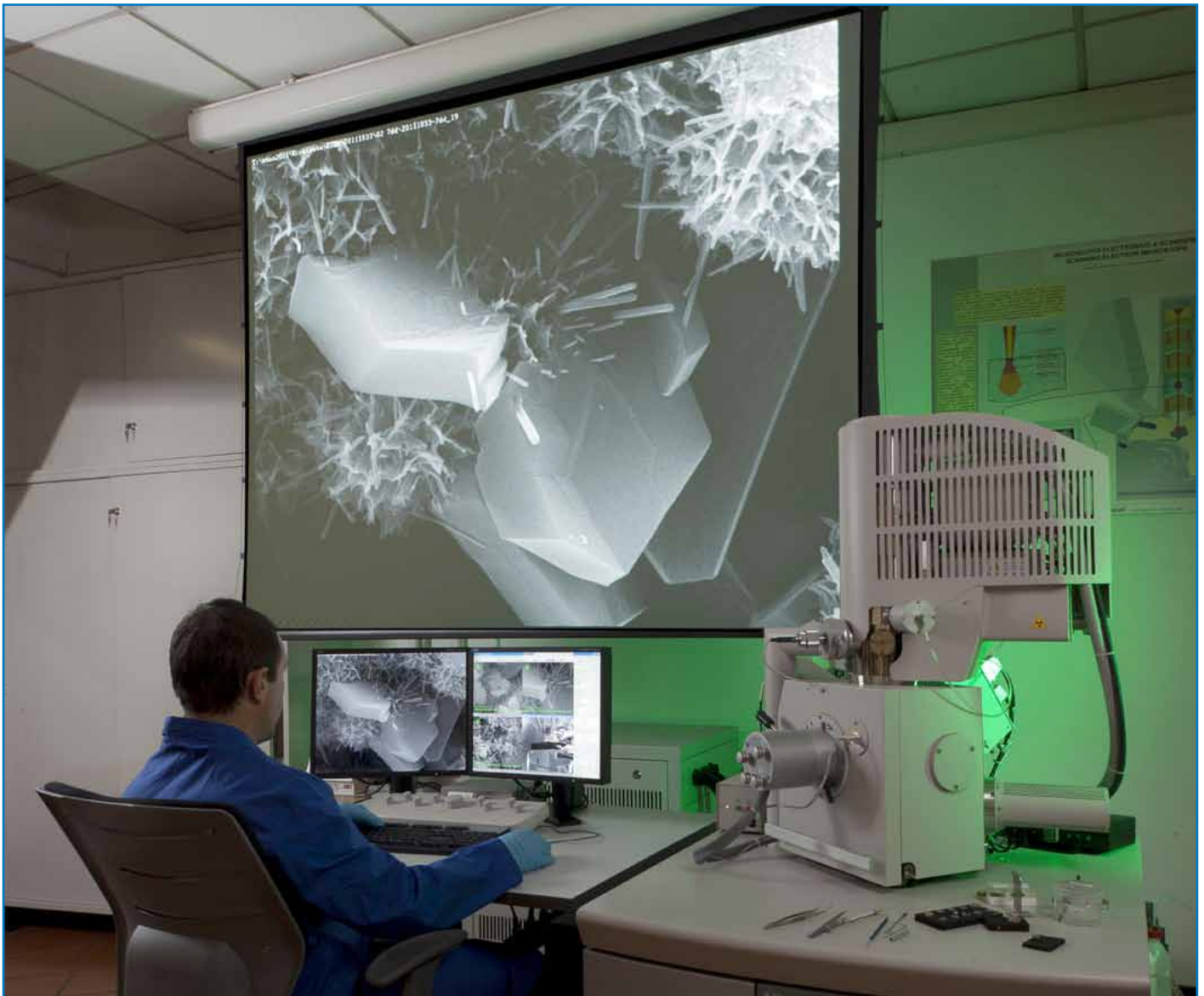
Microscopio electrónico ESEM-FEG
