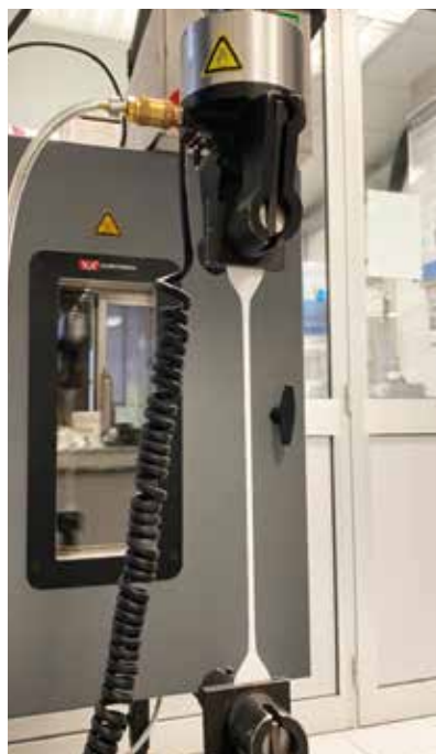
Laboratorio Mapei: ensayo de alargamiento de la membrana.
