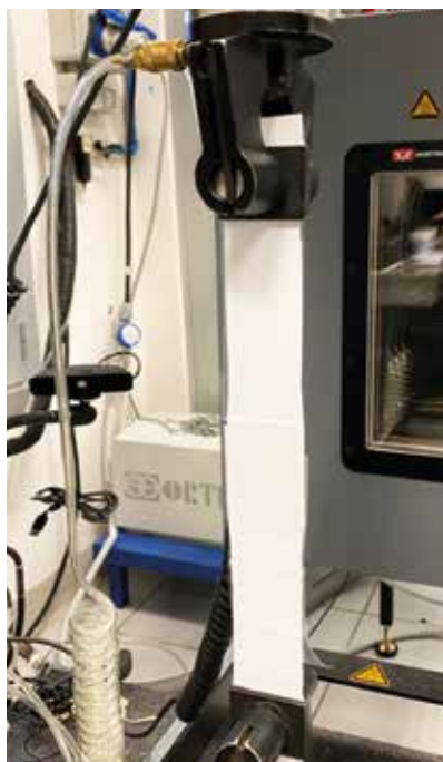
Laboratorio Mapei: ensayo de estanqueidad de juntas.
