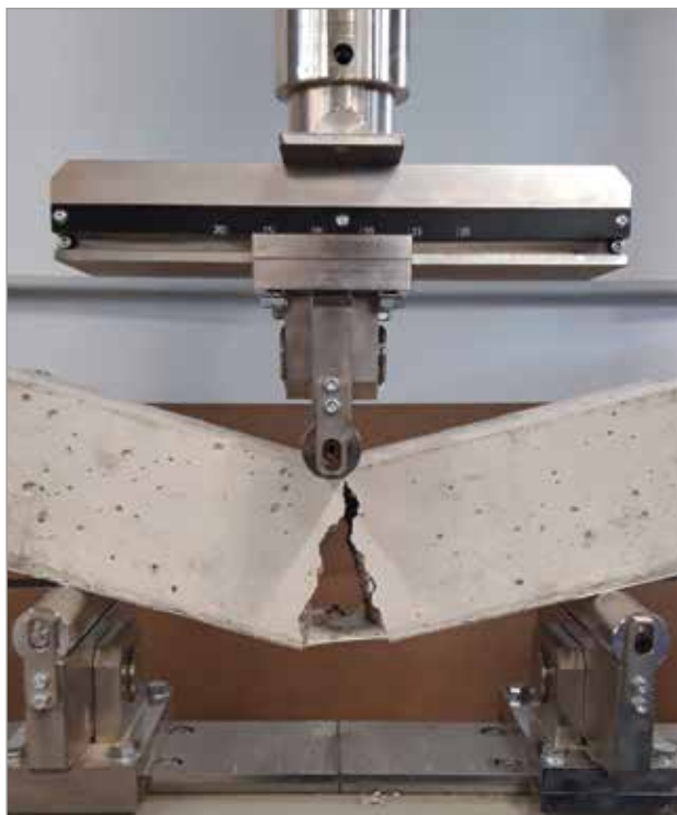
Fotografía tomada en el laboratorio mostrando la capacidad de puenteo de fisuras de Mapeproof FBT .
