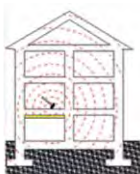
Figura 1. Los ruidos de impacto se propagan a través de las paredes, por lo que el aislamiento mediante falsos techos es ineficaz.
