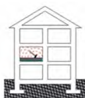
Figura 2. Un recredido flotante permite un mejor aislamiento acústico.
