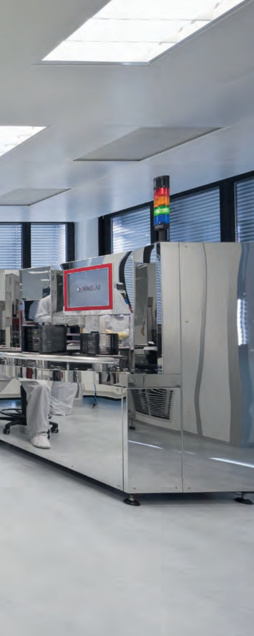
Microsalas utilizadas para evaluar los niveles de emisión de compuestos orgánicos volátiles.
