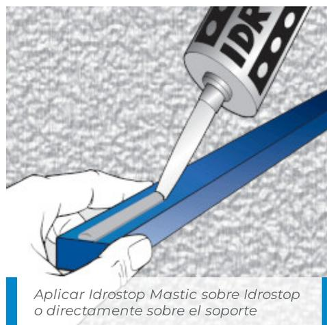
Aplicar Idrostop Mastic sobre Idrostop o directamente sobre el soporte
