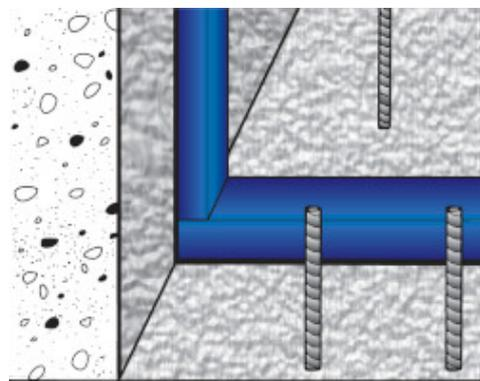
Unión con un ángulo entre pavimento y pared
