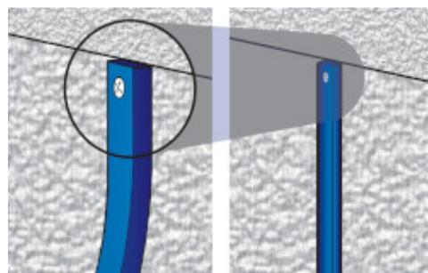
Piezas con un largo mayor a 1 m pueden colocarse en obra sobre superficies verticales fijándolas con clavos o tornillos por la parte superior y extrudiendo después Idrostop Mastic directamente sobre el soporte
