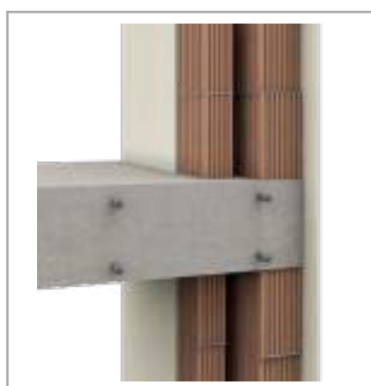
Стратиграфическое представление конструкции без теплоизоляции
