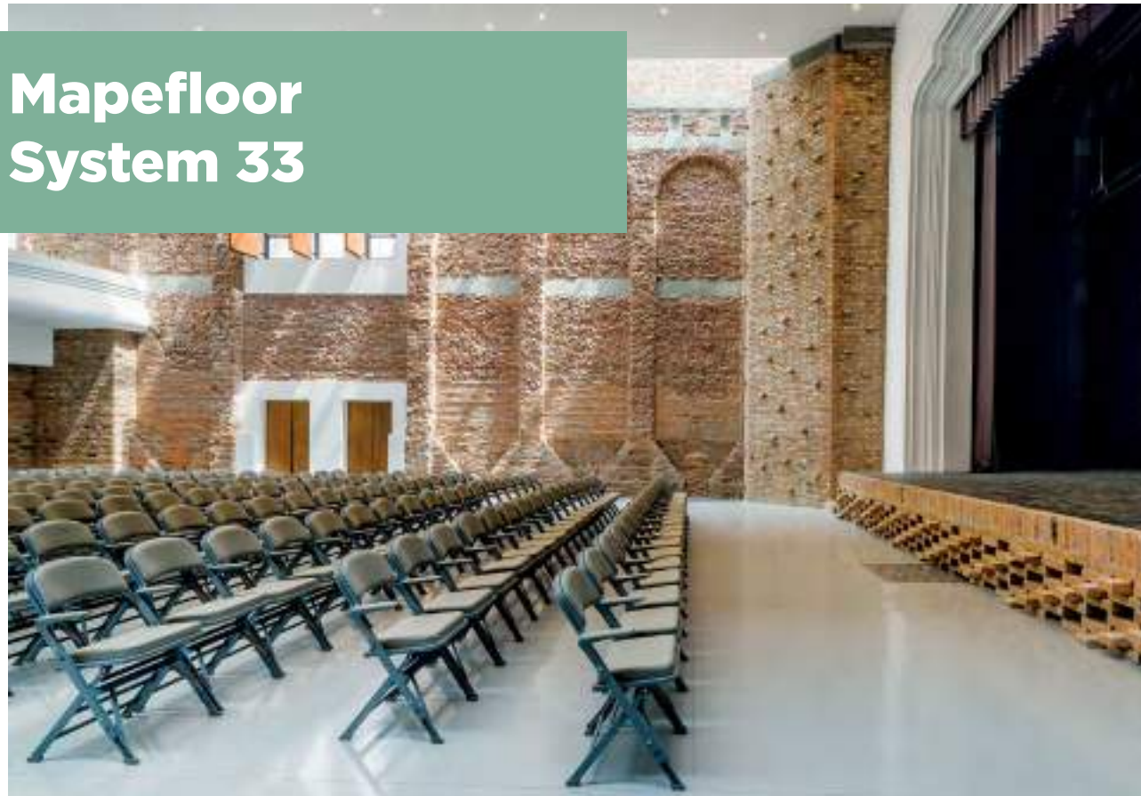
Гладкое глянцевое бесшовное эпоксидное напольное покрытие. Толщина 2-4 мм.
