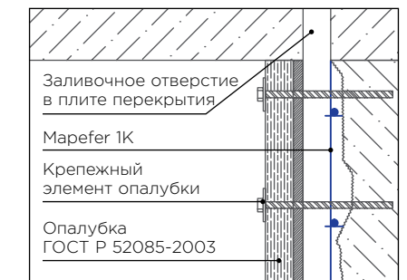
Монтаж опалубки и антикоррозийная защита арматуры
