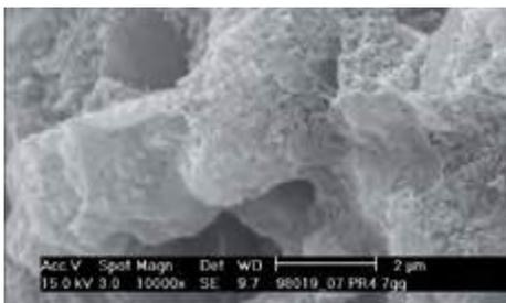
**Фото 4. Микроснимок раствора MAPE-ANTIQUE после 8 дней «старения». Обратите внимание: закругленная структура указывает на стабильность системы.**
