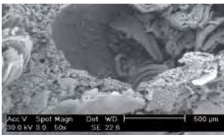
**Фото 2. Кристаллизация солей в макропорах осушающего раствора из направления MAPE-ANTIQUE**
