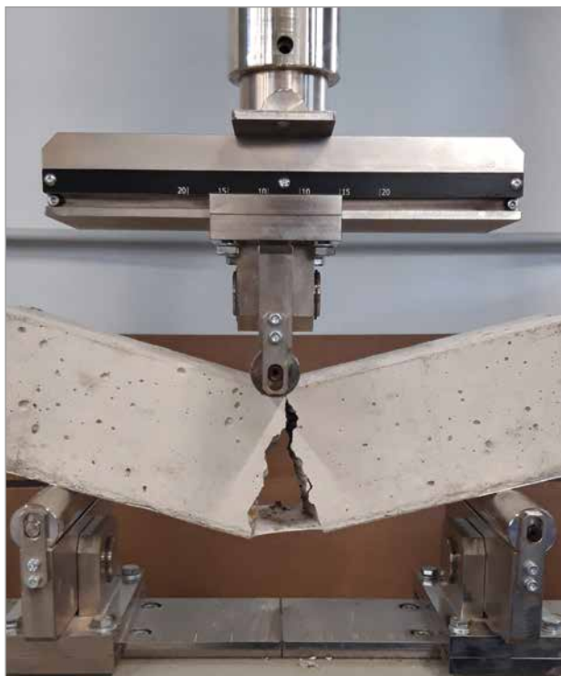
Fotografia z laboratória znázorňujúca schopnosť premostenia trhliny s použitím membrány Mapeproof FBT .
