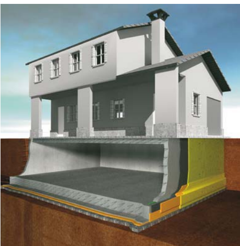
Tesnjenje podzemnih betonskih elementov konstrukcij
