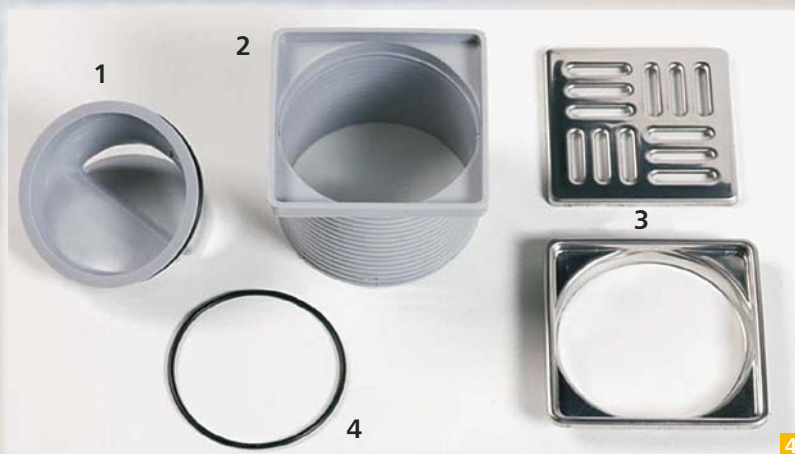
Slika 4: Sestava odtoka – Drain (1. protismradni pokrov; 2. teleskopski nastavek; 3. nerjaveča rešetka; 4. gumijasto tesnilo – O-ring)
