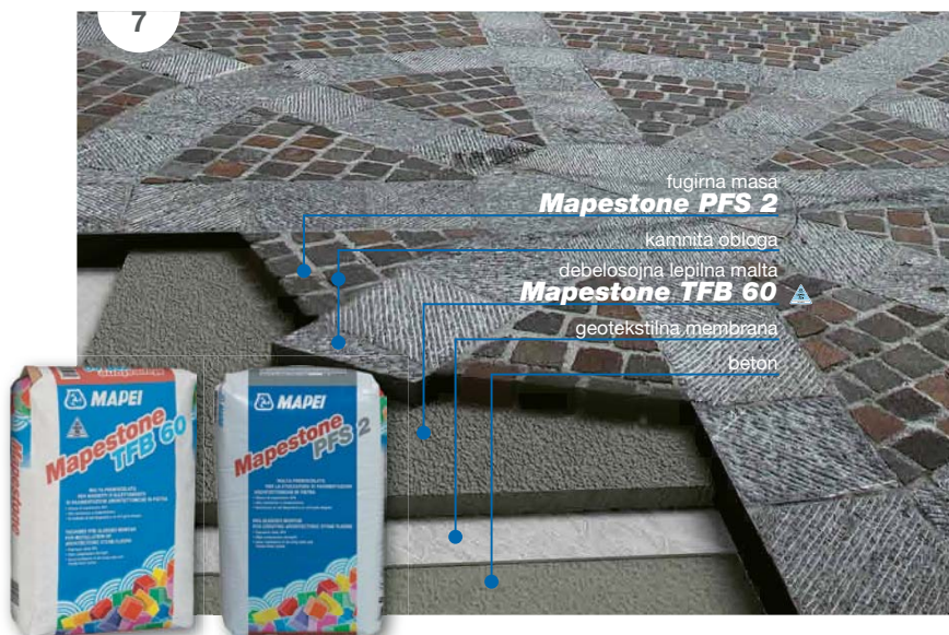
Slika 7: Sistemski prikaz polaganja tlakov iz kamnitih kock, naravnega kamna nepravilnih oblik in prodnika.
