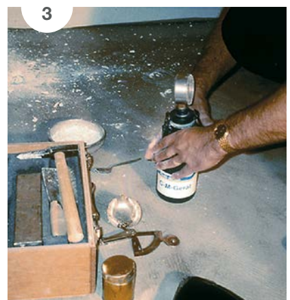
Slika 3: Meritev vlage po CM karbidni metodi.
