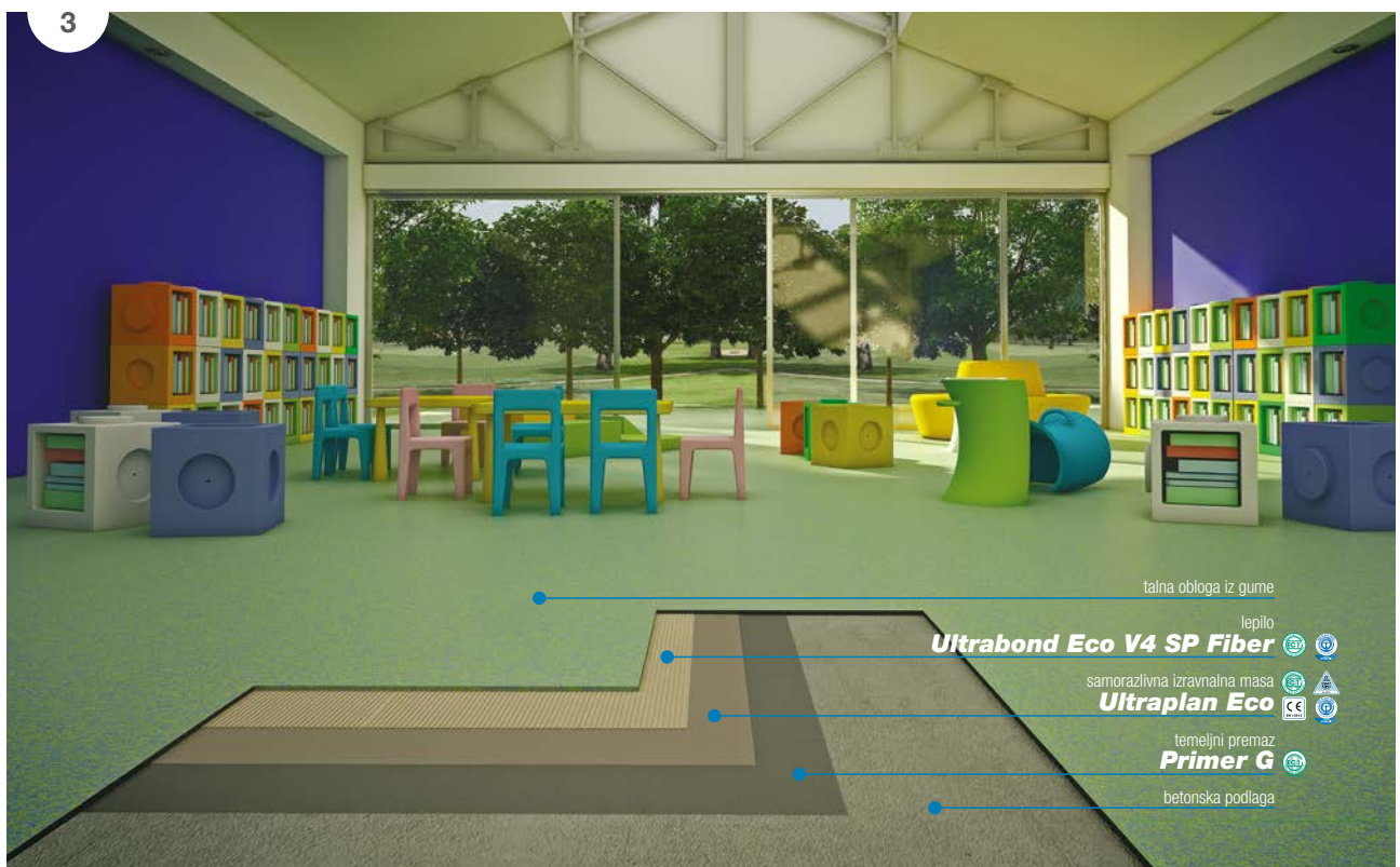
Slika 3: Sistem za polaganje talne obloge iz gume na betonsko podlago.
