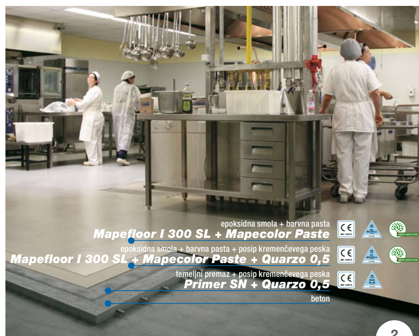
SLIKA 2: Nedrseči, večplastni epoksidni tlak (Mapefloor sistem 32) za mokre prostore (npr. kuhinja).
