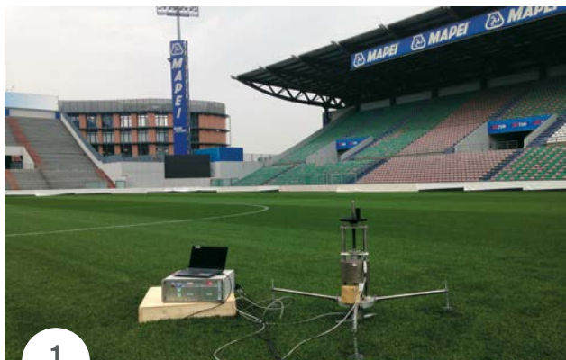
SLIKA 1: Naprava »berlinski atlet«, ki se uporablja za določanje lastnosti športnih površin v skladu s priporočili združenja FIFA.
