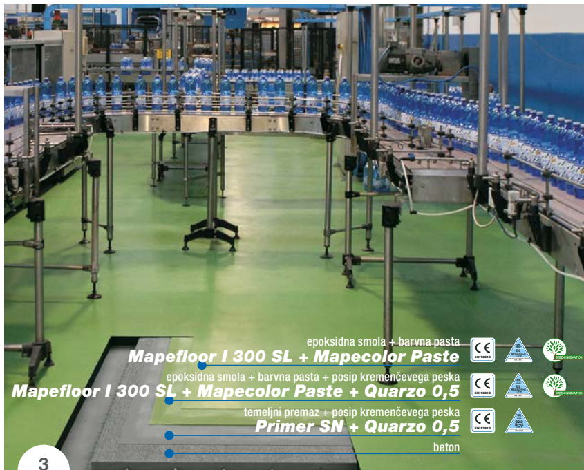
SLIKA 3: Nedrseči, večplastni epoksidni tlak (Mapefloor sistem 32) za suhe in mokre prostore (npr. polnilnica pijač).
