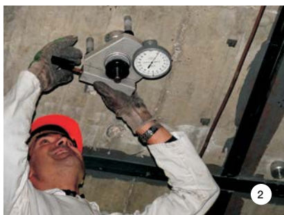
SLIKA 2: Izvedba meritev po metodi »pull-off«.
