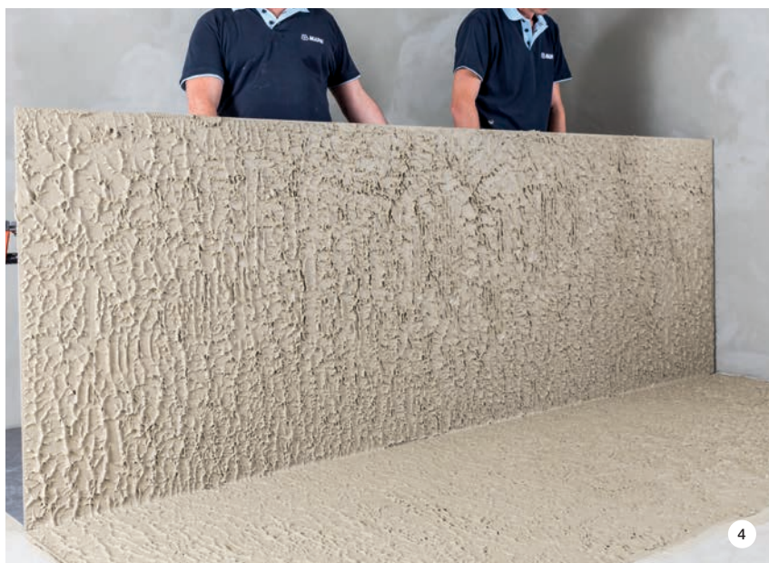
SLIKA 4: Popolna zlepljenost hrbtišča ploščice.
