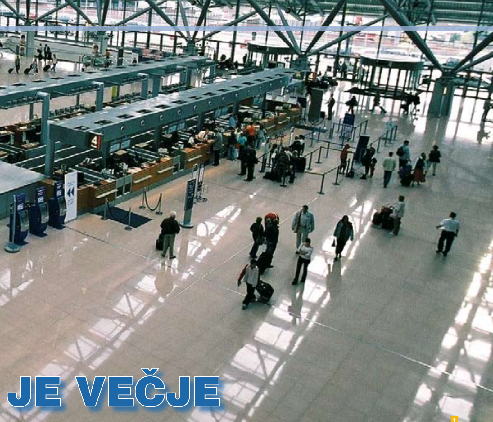
Slika 1: Tla iz granitnih plošč Salisbury Pink v prostorih za prijavo (»check-in«) v novem terminalu 1 letališča v Hamburgu Slika 2: Izvajanje talne obloge v prostorih za »check-in«. Plošče formata 60 x 60 x 3 cm so bile položene z lepilom MAPESTONE 1
