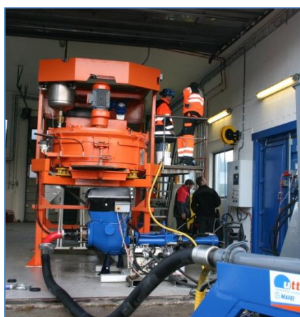
Betongblandare och pump.
