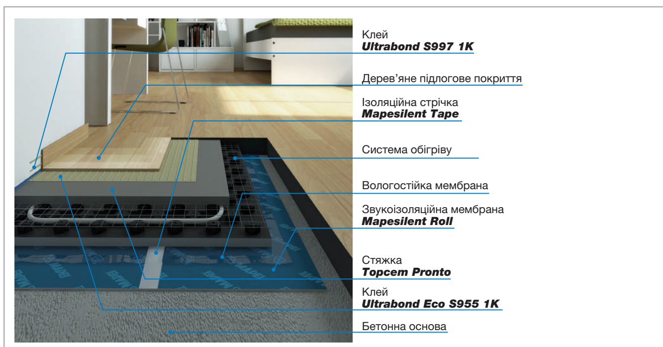
Рис. 4.8. Тепла стяжка із системою підігріву або охолодження
