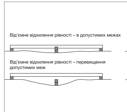
Рис. 3.6. Метод, що використовується для перевірки рівності підлоги
