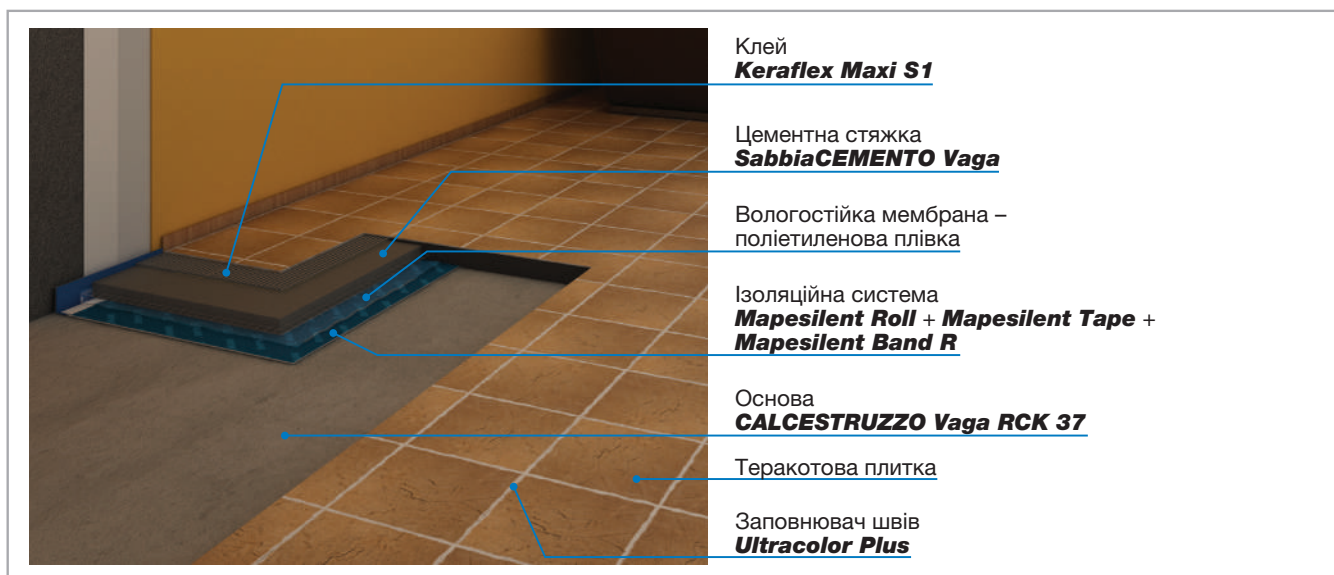
Рис. 4.3.2. Плаваюча стяжка із звукоізоляцією MAPESILENT SYSTEM
