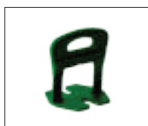
Розпірки MapeLevel ProWDG Spacer C Кольорові розпірки, що мають 7 варіантів товщини, залежно від ширини міжплиткових швів: 0,5 мм (помаранчеві), 1 мм (зелені), 1,5 мм (сірі), 2 мм (чорні), 3 мм (білі), 4 мм (жовті) та 5 мм (червоні). Для плитки товщиною від 3 мм до 12 мм.
