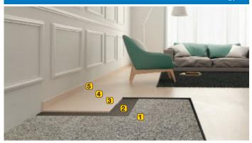
System for the installation of ceramic tiles on concrete/screed تطبيقات لتركيب بلاط السيراميك على الخرسانة/طبقة التسوية الأسمنتية (سكريد)
