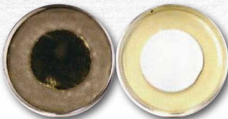
11. Prova di resistenza alla crescita di muffe in capsula di Petri, eseguita presso i laboratori di R&S Mapei. A sinistra: risultato del test su un'applicazione di pittura senza additivi antimuffa. A destra: risultato del test su Silancolor® Pittura Plus con tecnologia BioBlock®
