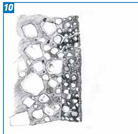
10. Parete dopo la pulizia con Silancolor® Cleaner Plus. Il risultato è ottimale: le alghe, le muffe e le ife sono state eliminate
