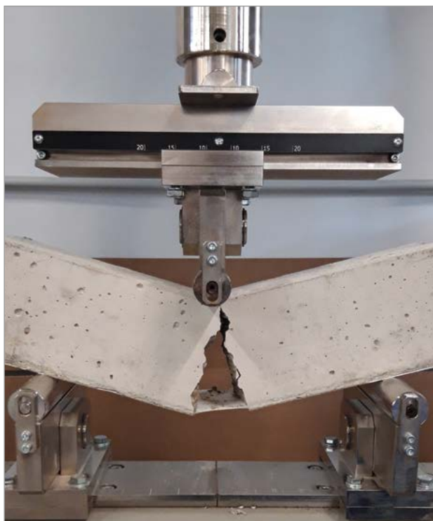
Photo prise en laboratoire montrant la capacité de pontage des fissures de Mepeproof FBT .
