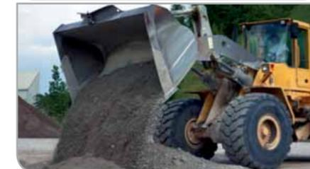
Nach wenigen Minuten Mischung mit **RE-CON ZERO** wird der Beton in einen gekörnten Stoff umgewandelt, der auf den Boden ausgelassen werden kann und nach der Reifezeit als Zuschlagstoff für Beton wiederverwertet werden kann. **RE-CON ZERO** funktioniert mit allen Arten von Beton.
