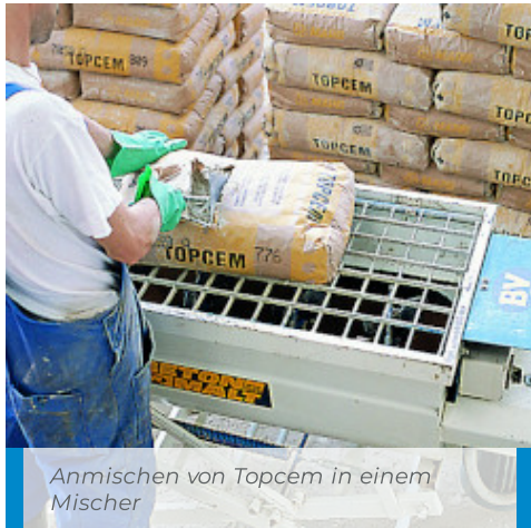
Anmischen von Topcem mithilfe einer automatischen Pumpeinheit
