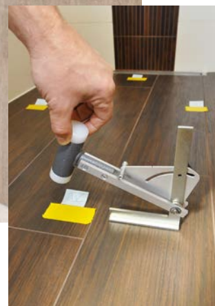
Empa-Pendelfallhammer Marteau basculant Empa
