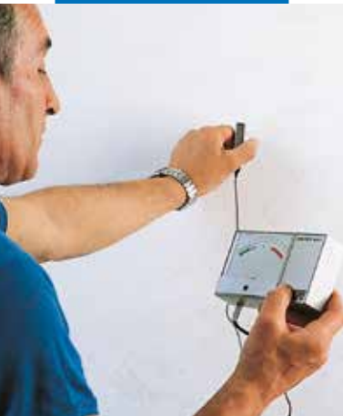
Kipskrohvi niiskuse kontrollimine
