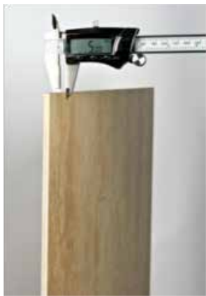
Figure 1 : Exemple d'un carreau de porcelaine mince de 5 mm
